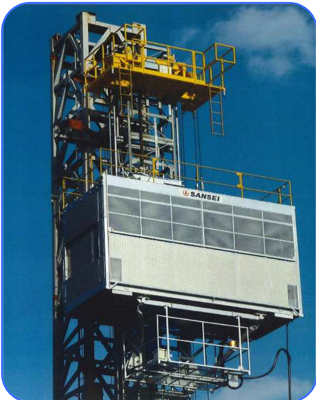
■工事用エレベーター（積載3000 k g）
