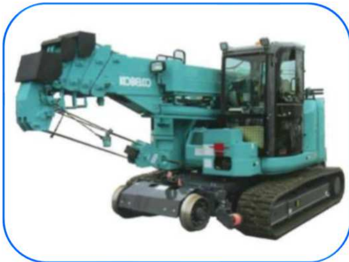
■ 4.9 t クローラークレーン
